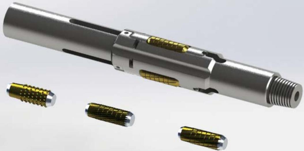
滚轮稳定器可以在硬的或研磨性岩层保持井眼的标准直径。当钻头磨损到小于标准尺寸时，滚轮稳定器可以扩大井底井径到标准井径。无论直井还是定向井，滚轮稳定器可以确保后面的钻头或套管能下入正常井径尺寸。滚轮稳定器的特点是与井壁的摩擦阻力小，耐磨性强，使用寿命长，其滚轮在钻井平台上更换容易。而滚轮又分为镶齿型（用于研磨性地层）、窄齿型（用于硬地层）、宽齿型（用于软地层）三种。
