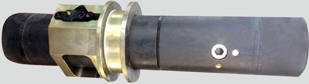
顶部驱动阀用于顶驱钻井装置上，可分为顶驱上旋塞阀和顶驱下旋塞阀两种，它们是与顶驱系统配套使用的一种控制阀，通常情况下两个阀串接与顶部驱动钻井装置上。该阀可承受来自上，下两方向的高压。其工作压力可达 10,000psi 或 15,000psi。阀体内腔及零件均经过特殊的防腐处理，延长了使用寿命。
